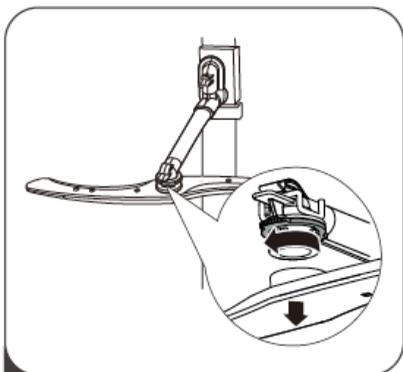
**1** Pour retirer le bras d'aspersion supérieur, maintenez l'écrou et faites tourner le bras dans le sens des aiguilles d'une montre.
